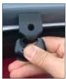
Ein einzelnes Schloss zum Schließen der Kabine ist hinter der linken Schulter des Piloten angebracht.
