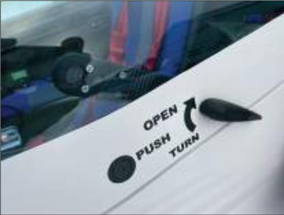
Prototyp der neuen Verriegelung.
