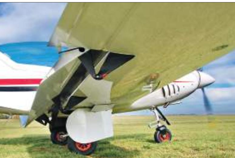
Das Einziehfahrwerk verfügt über einen Klappmechanismus, so dass sich im eingefahrenen Zustand ein sauberes NACA-Profil des Flügels ergibt.
