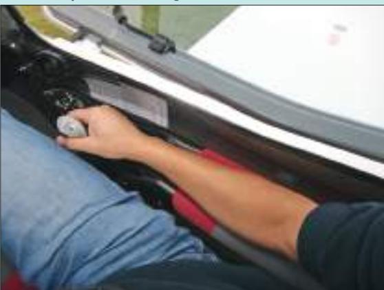
Die Vorbehalte gegenüber dem Exzenter-Mechanismus zur Kabinenverriegelung waren um einige Haifischlängen größer. Alle bemängelten die problematische Bedienung, insbesondere vom vorderen Pilotensitz aus, und die schwierige visuelle Kontrolle - beide Teile sind schwarz, so dass nicht auf den ersten Blick erkennbar ist, ob sie verriegelt und die Kabine gesichert ist. Eine bessere Lösung ist jedoch bereits in der Testphase und wird nach den erforderlichen Genehmigungen in Produktion gehen.
