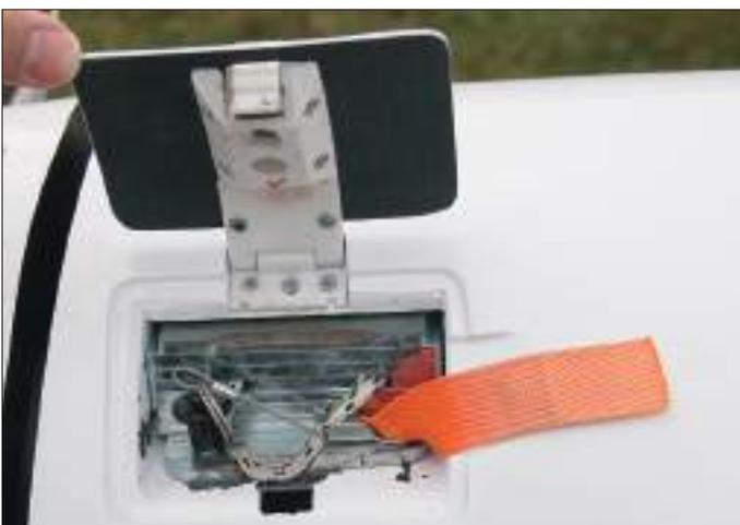
Shift Weight beachten: In einen offenen Schacht in der Cowling muss im Zweipersonen-Betrieb ein Metallklotz eingeschoben werden (600 kg MTOM-Version). Die orangefarbene Flagge ist von der Kabine aus sichtbar.
