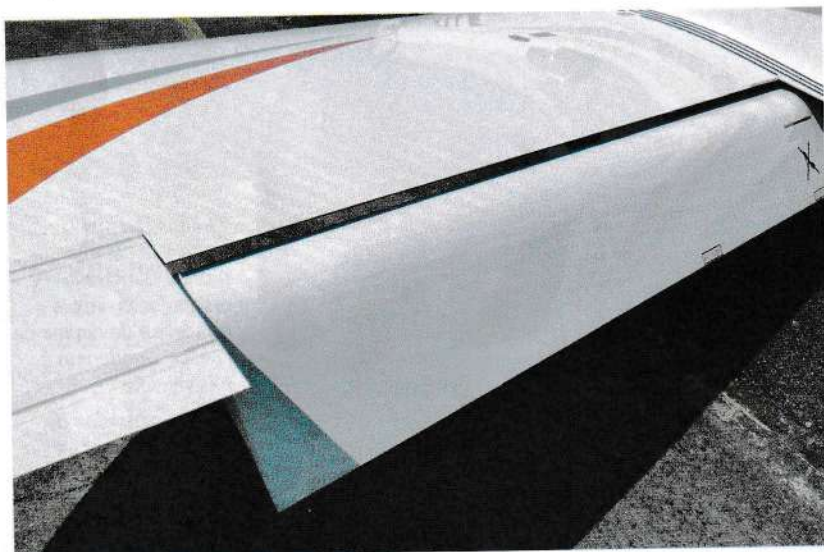
Les volets sont de type Fowler : une fente apparaît entre l'aile et le volet sorti, favorisant le soufflage de ce dernier.
