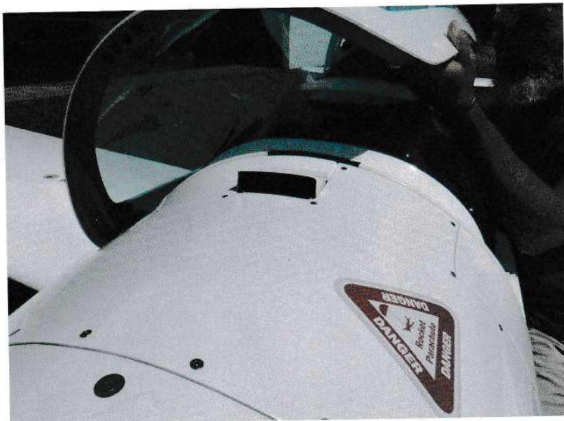
Le parachute de secours prend place derrière la cloison pare-feu. On voit aussi l'écope de ventilation de la cabine.
