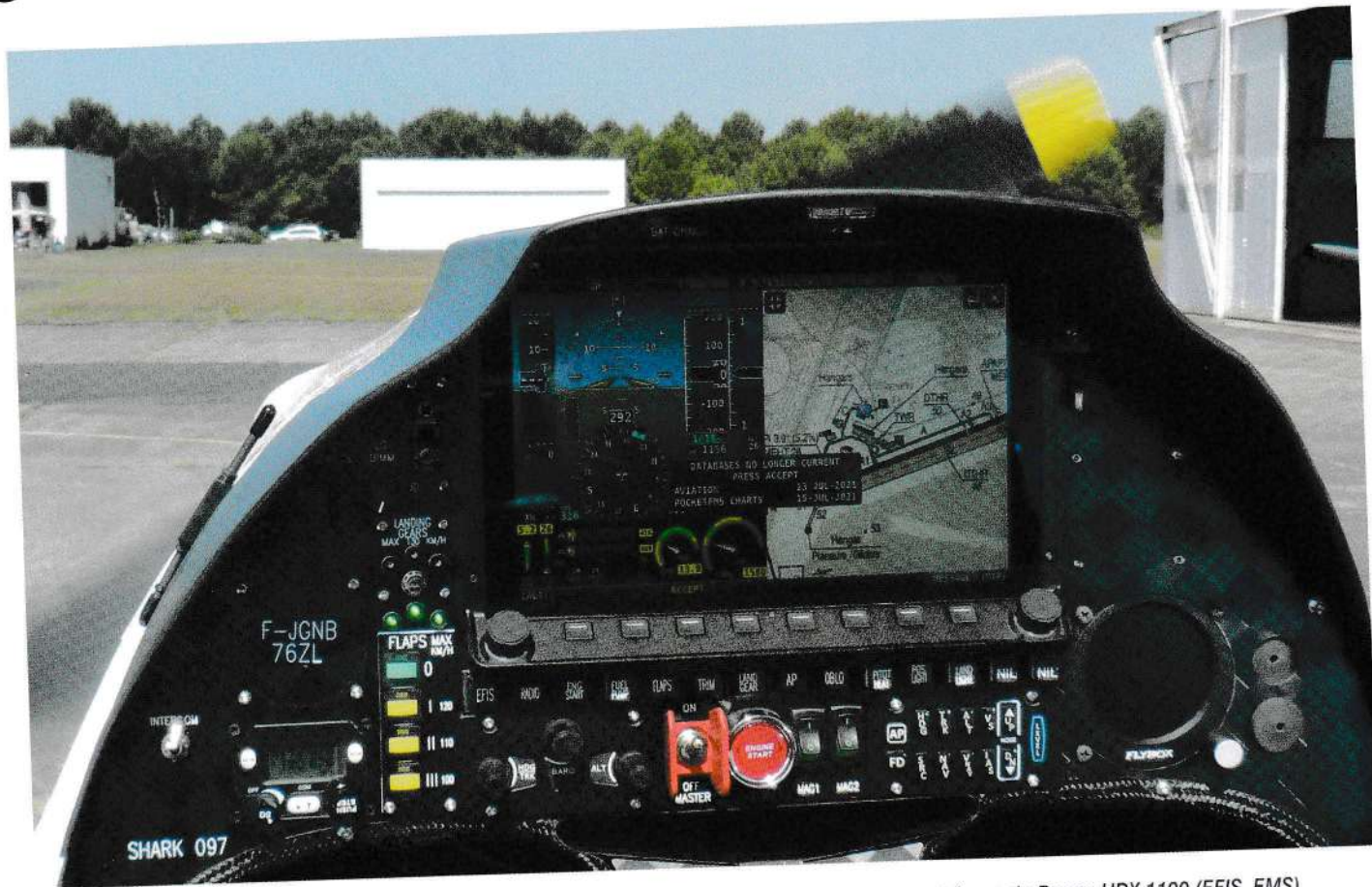
Le grand écran du Dynon HDX 1100 (EFIS, EMS) occupe l'espace central. En dessous, les fusibles, puis les commandes de pilote automatique et d'allumage moteur. À gauche, les panneaux de contrôle du train rentrant et des volets, puis en bas la radio. À droite, l'EFIS Flybox sert d'instrument de secours.
